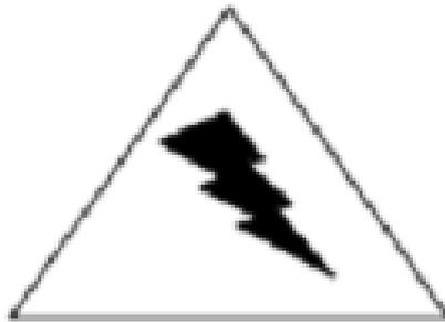
切断有源滤波器主回路后，等待至少 3 分钟，确保直流侧电压降至 10V 后再进行后续维护。
