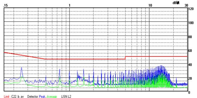
WRE2405S-1WR2 传导骚扰 Class B 测试效果图（负线）
