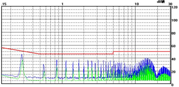
WRF2405S-1WR2 传导骚扰 Class B 测试效果图（正线）
