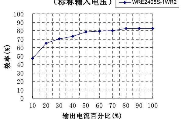
效率VS输入电压曲线图
