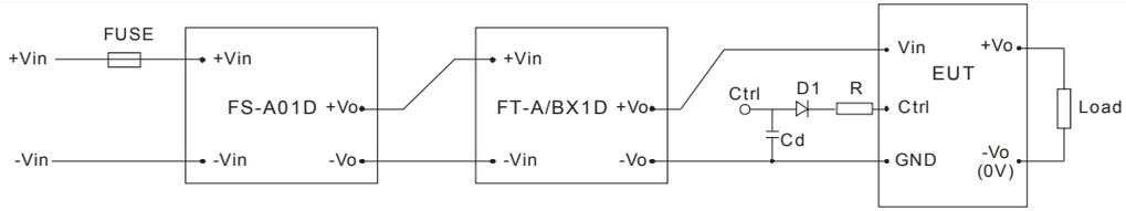
FS-A01D、FT-A/BX1D 为我司脉冲群抑制器，具体型号请参照选型手册
