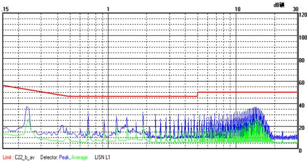
WRE2405S-1WR2 传导骚扰 Class B 测试效果图（正线）
