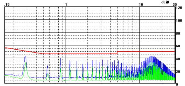
WRF2405S-1WR2 传导骚扰 Class B 测试效果图（负线）
