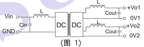
但应注意电感值的选取及“LC”滤波网络其自身的频率应与DC/DC频率错开, 避免相互干扰。并选用合适的滤波电容。若电容太大, 很可能造成启动问题。对于每一路输出, 在确保安全可靠工作的条件下, 其推荐容性负载值详见(表1)
