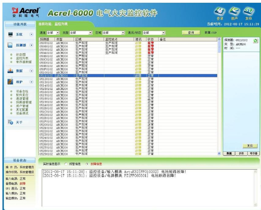
图 14 设备故障、探测器通讯故障信息提示界面
