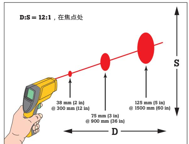
当测量较小的物体时, 请在与待测目标相距 6 ft. (1.75 m) 的范围内使用 Fluke 561。测量区域随着距离的增加而扩大 (约等于距离除以 12)。
